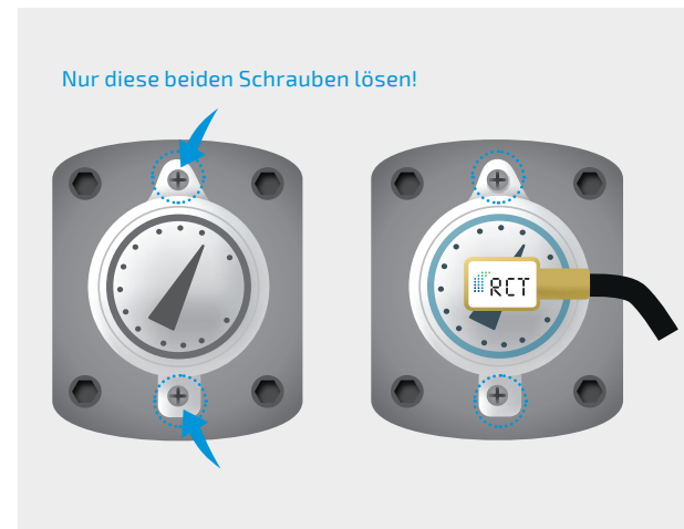
Abb. 2+3 | Original Anzeigehuhr entfernen und RCT-Sensor einsetzen
