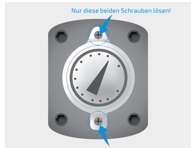
Abb. 2 | Originale Anzeigehuhr entfernen
